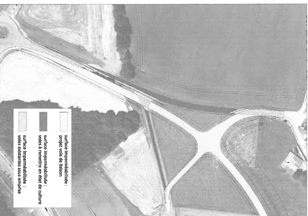
Détail sur les surfaces imperméabilisées au droit du raccordement de la RD 93 sur la voie de liaison
